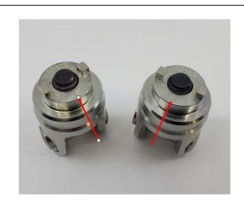
15. NOTING WHICH ARE THE DRIVER/PASSENGER SIDE TIE RODS (LOGO ON TIE ROD SHOULD READ CORRECT FROM FRONT OF CAR). UNSCREW THE HEIM JOINT AND JAM NUT FROM THE TIE ROD. INSTALL THE HEIM JOINTS USING THE PINS AND CLIPS. (SNAP RING PLIERS).
